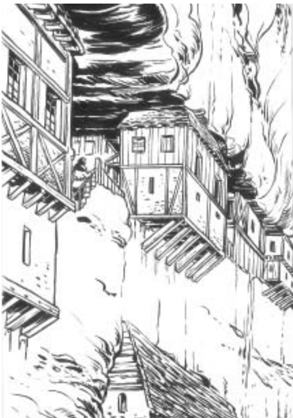
maison à encorbellements
