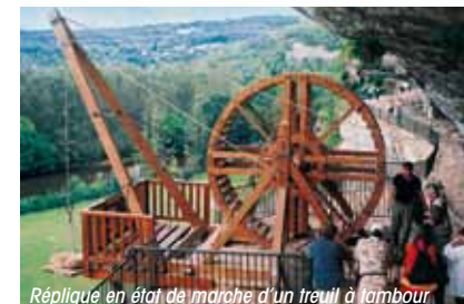
Réplique en état de marche d'un treuil à l'ombour
